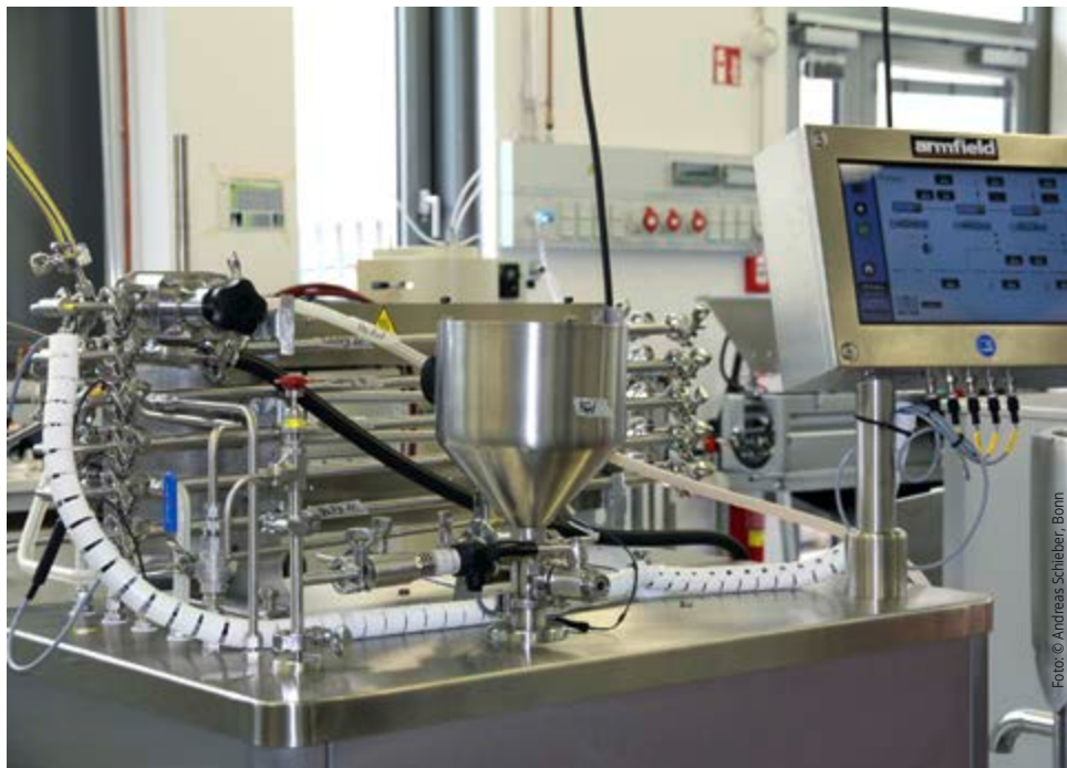
Der Röhrenwärmeaustauscher ist ein typisches Beispiel für konventionelle Verfahren der Lebensmittelverarbeitung. Er eignet sich für die Erhitzung flüssiger und pastöser Produkte.
