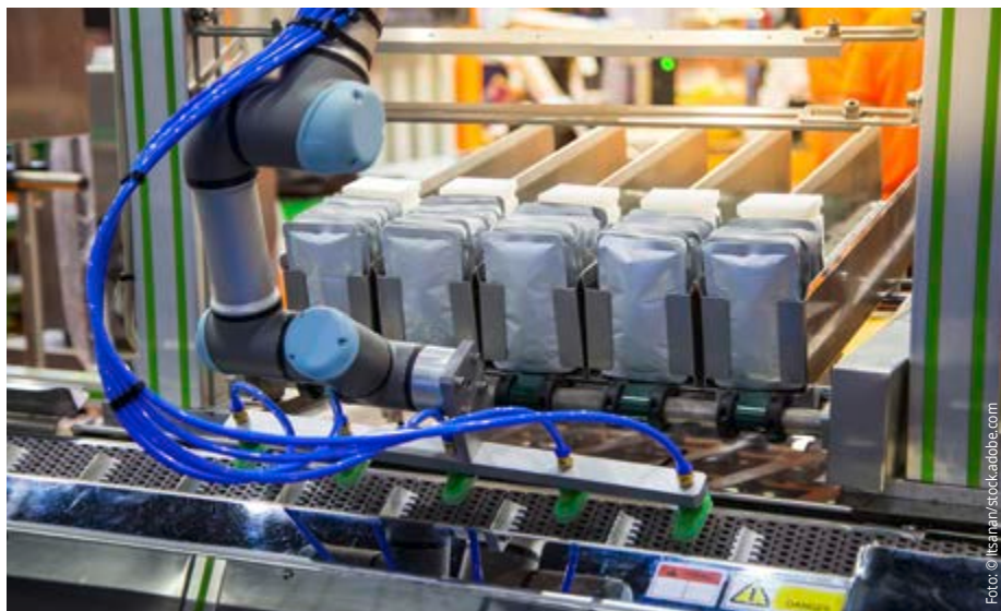
Einsatz der Ultraschalltechnologie in der Materialwissenschaft: Lebensmittelverpackungen werden auf Dichtigkeit geprüft.
